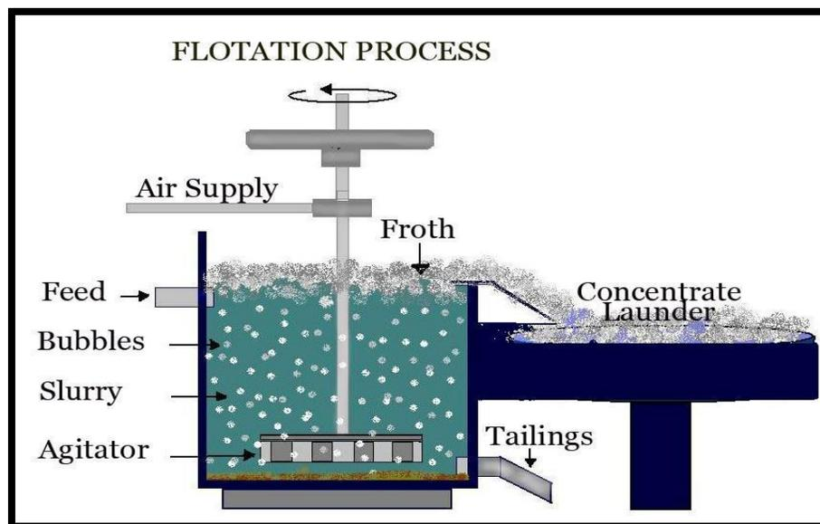
**Fig. 14: Froth Flotation Cell Operation**
