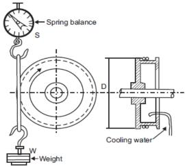
Fig. 30. Rope brake
