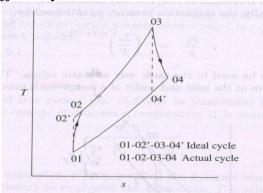
Fig. 50. T-S diagram of actual cycle
