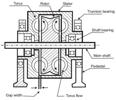
Fig. 31. Hydraulic dynamometer
