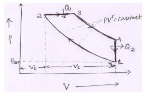
Fig. 8. Diesel cycle
